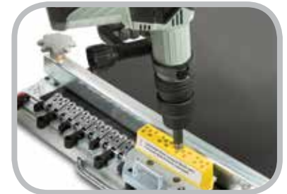
電動リベットドライバーの操作
